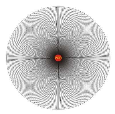
Como podemos apreciar en la figura desde el VOR<sup>1</sup> se originan radiales que tienen la particularidad de portar una señal que nos indica la dirección de la estación.
