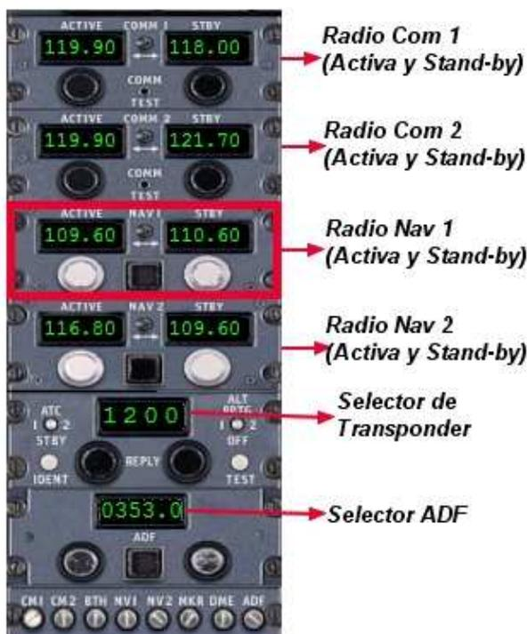
y sintonizar la frecuencia en el NAV 1, en la sección activa, como indica el dibujo recuadrado en rojo. La frecuencia que estamos usando es la de la pista 13 del **Aeroparque Jorge Newbery (AEP/SABE)**. En nuestra frecuencia de Stand-by tenemos otra radio sintonizada. Recordemos que para sintonizar una radio y activarla, debemos introducirla primero en la frecuencia de Stand-by y luego pasar la a la Activa mediante el selector del medio.
