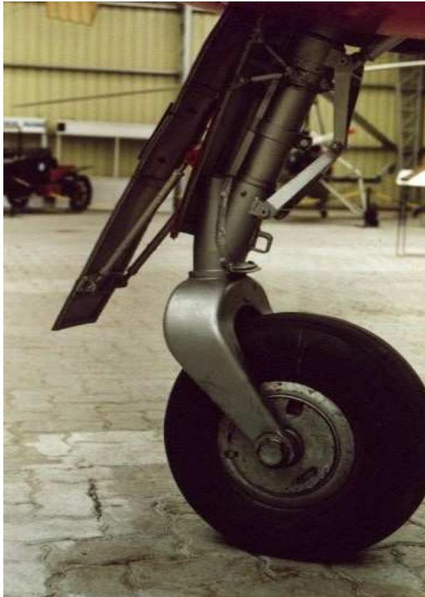
Se nota la robustez del tren de aterrizaje, la rueda que tiene puesta en el tren delantero no es de ese avión sino que la sacaron de un patín trasero de un Junkers 52 que había en la fábrica que, cuando no volaba, se le sacaban cosas para otros aviones.
